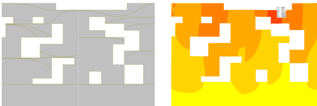
Fig. 3 – Alçado com representação do traçado dos cabos de pré-esforço e respectivas deformações
